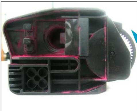
31. Para asegurar que el sensor de toner funcione adecuadamente girar el engranaje del lado opuesto de la tapa azul.
