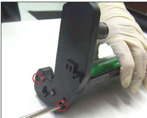
16. Sacar la tapa lateral mayor destornillando los tornillos indicados por los círculos.
