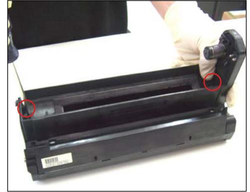
3. Separar la unidad de cilindro de la cubierta plástica sacando los dos tornillos indicados por los círculos.
