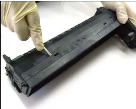
4. Colocar la cubierta invertida y destrobar las lengüetas inferiores con ayuda de un desarmador plano pequeño.
