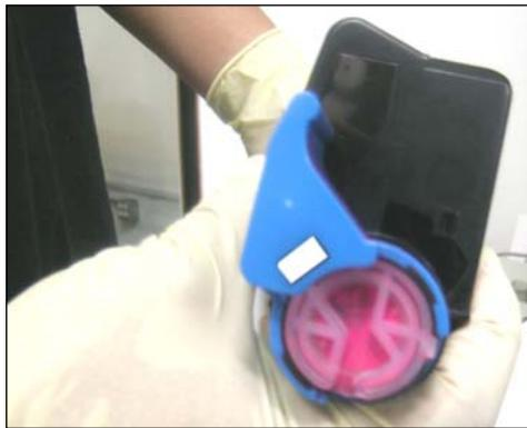
32. Un giro completo del engranaje hará que la lengüeta blanca levante y desaparezca completamente de la ventana.
