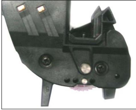
11. Vista ampliada de la tapa lateral mas pequeña mostrando los dos tornillos.
