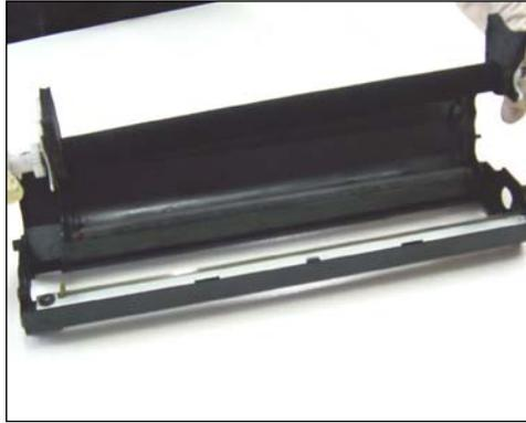
20. Sacar el rodillo de alimentación y sus componentes como se muestra.
