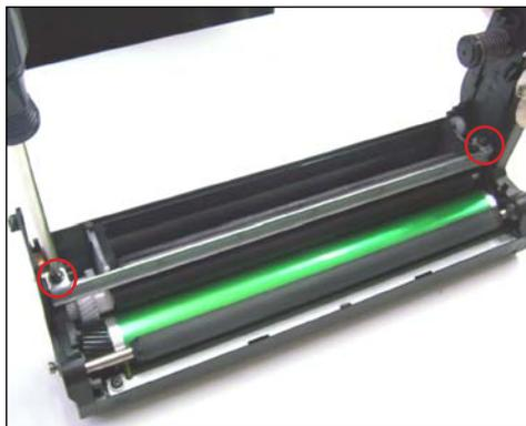
8. Destornillar los dos tornillos en los extremos de la cuchilla dosificadora que soportan y mantienen las tapas laterales.
