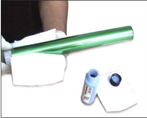
19. Aplicar la "OPC Drum Coating Cream" #501 de Uninet para preservar el cilindro OEM.
